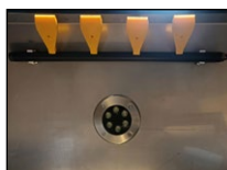
Soufflage vitre et éclairage LED
